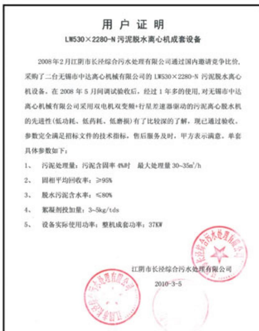
于2008年2月选用了我公司2套 LW530×2280-N 污泥离心脱水成套装置（机械差速），当进料浓度4%时，最大处理量达到30~35m³/h，脱水泥饼含水75~80%。
