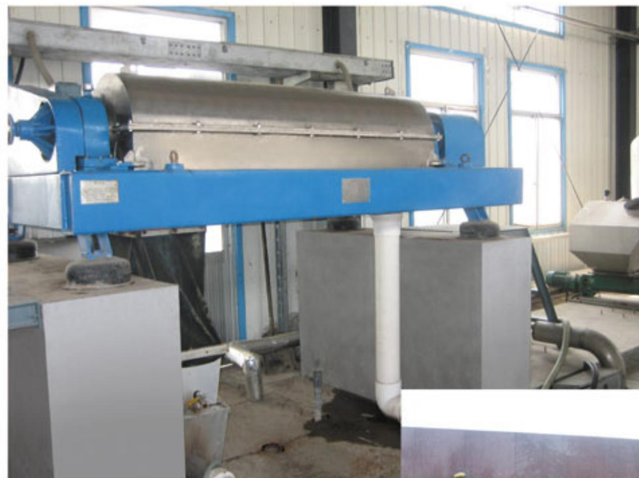
选用了我公司1套LW400×1800-N 污泥离心脱水成套装置（机械差速），当进料浓度2~3%时，最大处理量达到12m<sup>3</sup>/h，脱水泥饼含水75~80%。
