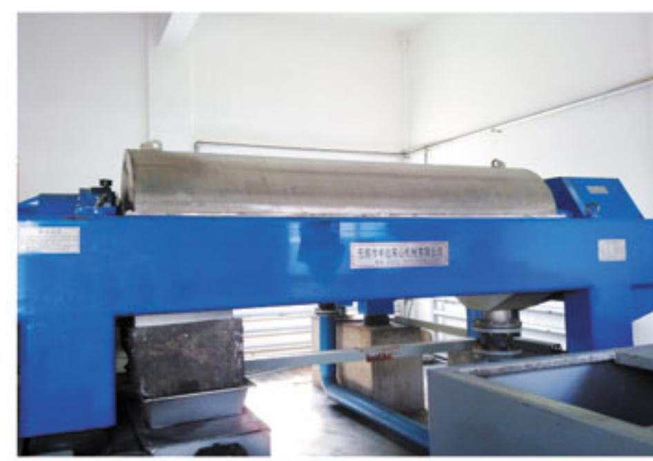
于2009年选用了我公司2套LW450×2000-N污泥离心脱水成套装置（机械差速），处理煤矿污泥。
