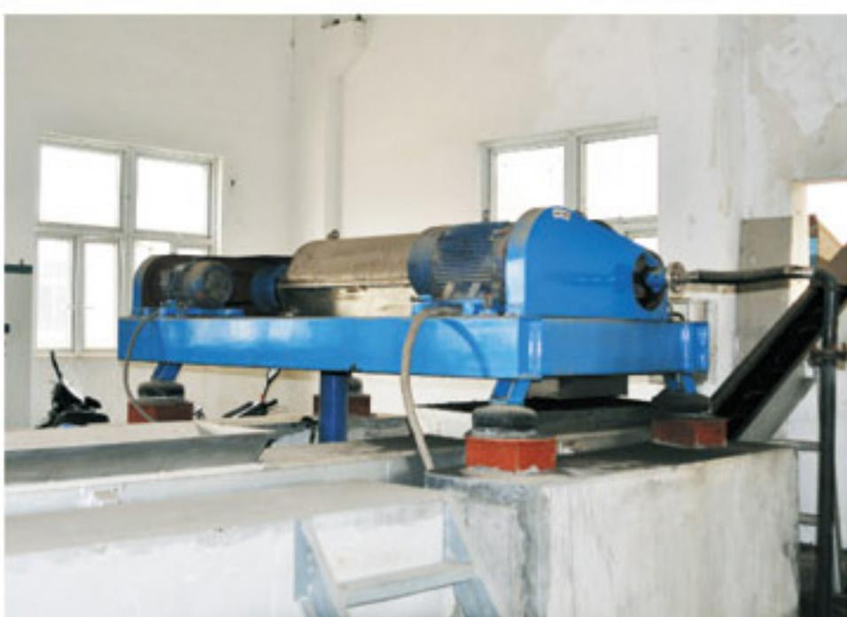
于2008年7月选用了我公司4套LW400×1800-N污泥离心脱水成套装置（机械差速），分别安装于无锡市锡山区安镇污水处理厂、鹅湖污水处理厂、锡北污水处理厂、东港污水处理厂。当进料浓度2~3%时，最大处理量达到12m<sup>3</sup>/h，脱水泥饼含水75~78%。
